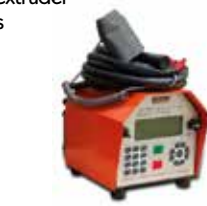
Heizwendelschweißen electro fusion welding
