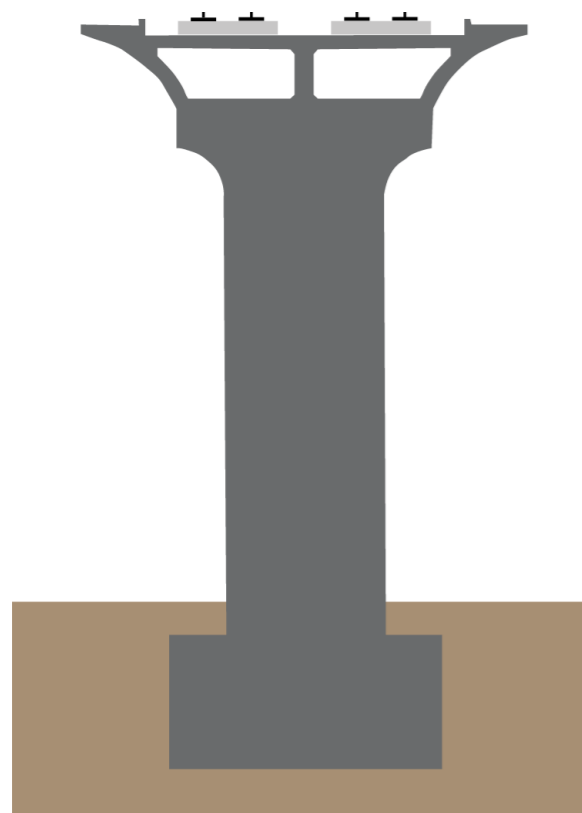
Figur 5.48. Skiss över dubbelspårig betongbro på fast mark.
