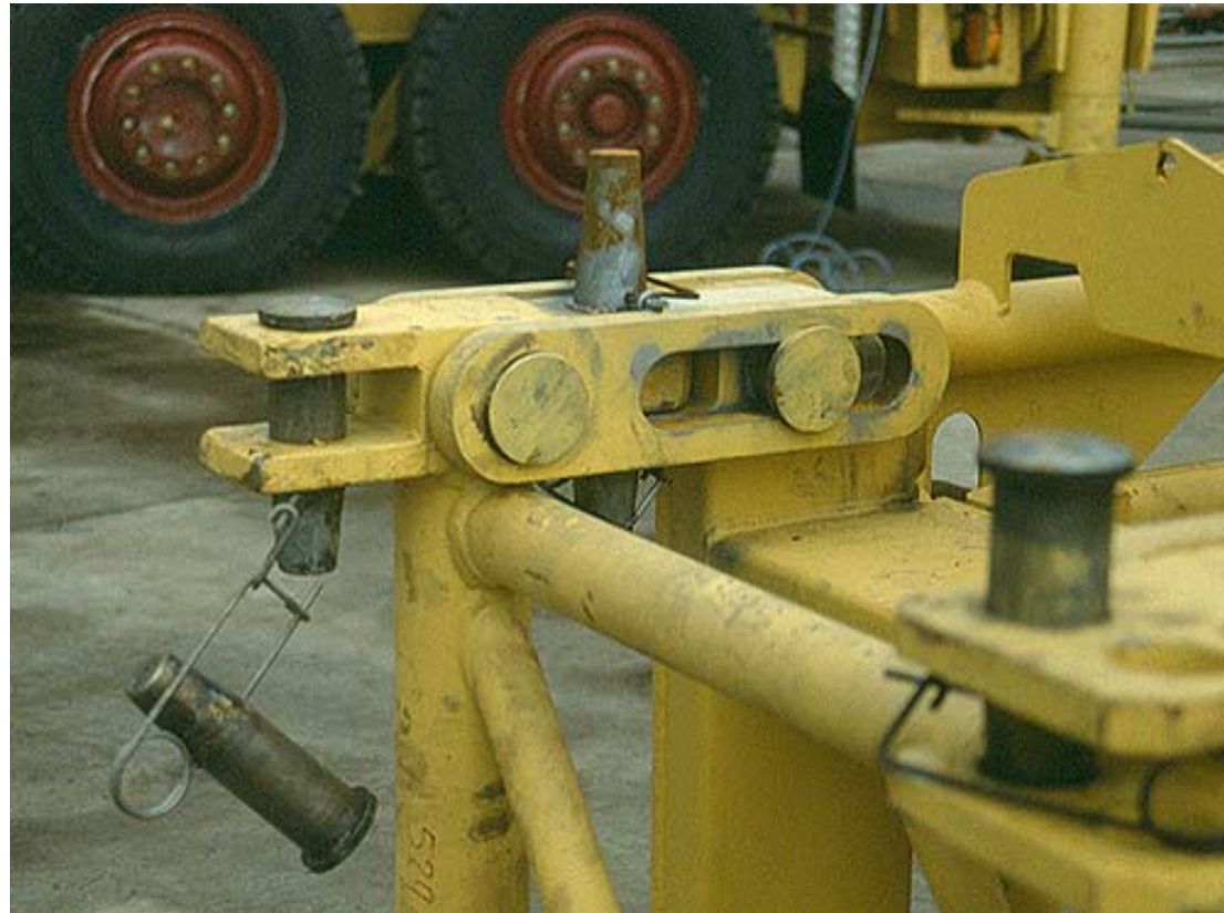
Anwendung von Bolzen – mit Splint gesicherter Kranbolzen
