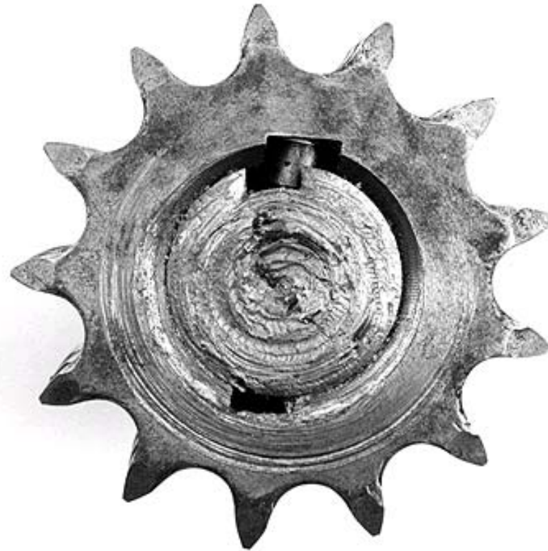
Verformte Passfederverbindung unter mehrfacher statischer Überlast
