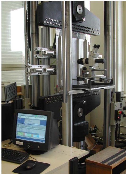
rechts: Servohydraulische Prüfanlage der Firma Instron
