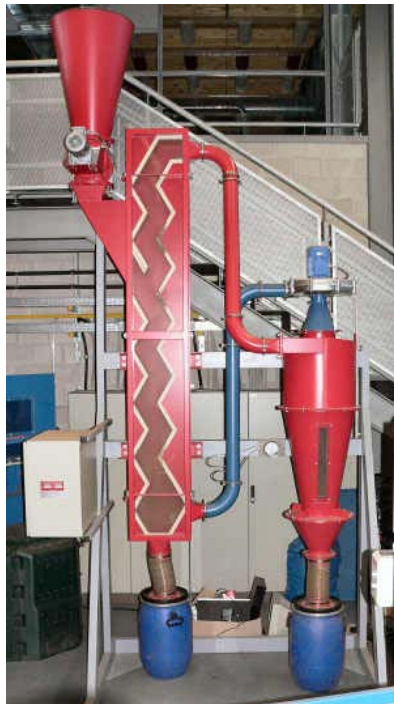
Windsichter basierend auf Schwerkraft (dient zur Erklärung der Funktionsweise)
