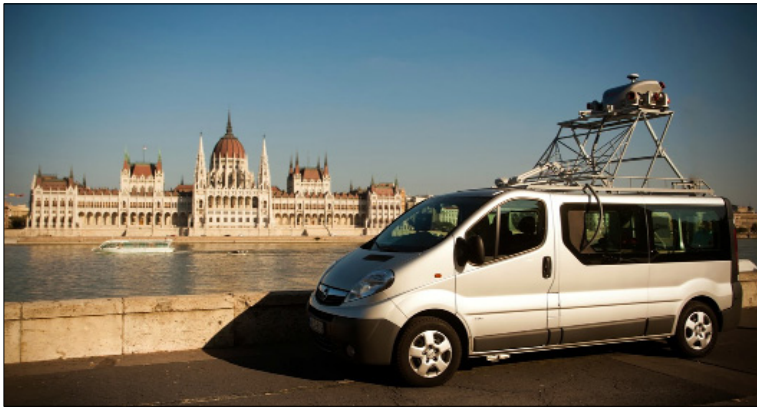
1. ábra A Budapest Közút mobil lézershennere a hordozó autóval
