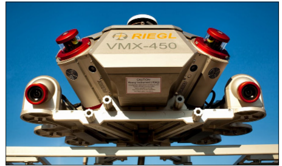
2. ábra A mobil lézershennere közelebbről (Felül két oldalt látható a két lézershennere fej, lentebb a hat darab kamera, középen a navigációs egység.)
