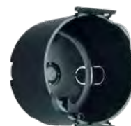
Berührungsschutzkappe I. Abgang 1 x Kabel. Einbau-ø 49,5 mm, Einbautiefe 35 mm. Nr. 80916 2,35 Berührungsschutzkappe II. Abgang 2 x Kabel. Einbau-ø 46 mm, Einbautiefe 45 mm. Nr. 80918 2,75
