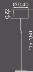
310333-01 nickel-matt/ Chrom abgesetzt H. 1,15-1,60 m 3 × E27 Serien-Zugschalter Schirm S043-01, Ø 0,40 m, H. 0,22 m
