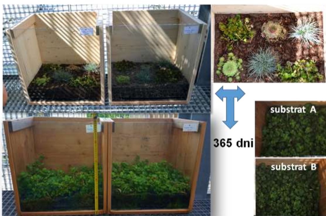
Slika 2: Prilagoditev rastlin v pilotnih modelih v obdobju enega leta. Na sliki je prikazana zasaditev rastlin ( t_0 ), ki je bila enaka v obeh modelih ter rast zasajenih rastlin po končanem obdobju spremljanja fizikalno kemijskih parametrov in fotodokumentiranja ( t_{365} ).
