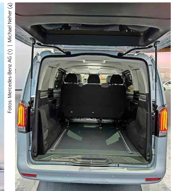
Für die gewerblichen Personentransporter bietet Mercedes erstmals eine elektrische Heckklappe an.
