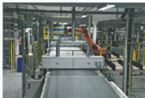
Nach der beidseitigen Pulverbeschichtung laufen die Platten zum Roboter zur exakten Furnierlegung
