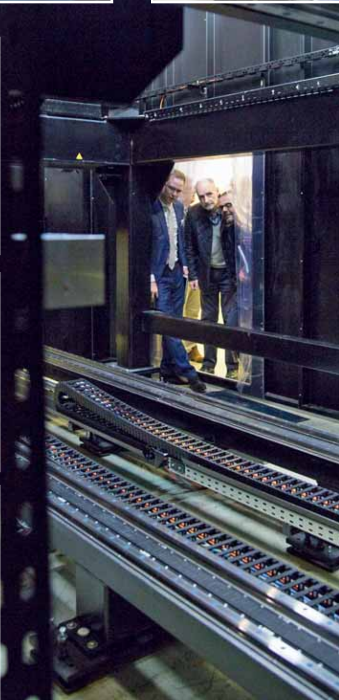
Die neueste Generation der „Jupiter“-Digitaldruckanlagen verfügt über eine neue Beschickung mit dem „Tandem Transport Linear“-System (links, Mitte) und über Druckköpfe mit Doppelbestückung der Serie „Xaar X 2001“. Auch Einblicke in die Tiefen der Technik waren bei der Hausmesse möglich
