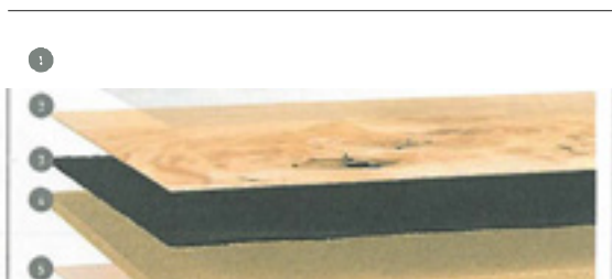
Der Produktaufbau von Woodura: Öl oder Lack (1), Holzlayer (2), holzbasierte Pulverschicht (3), feuchtereisistente HDF (4), Gegenzuglayer (5) (Bild: Välinge)
