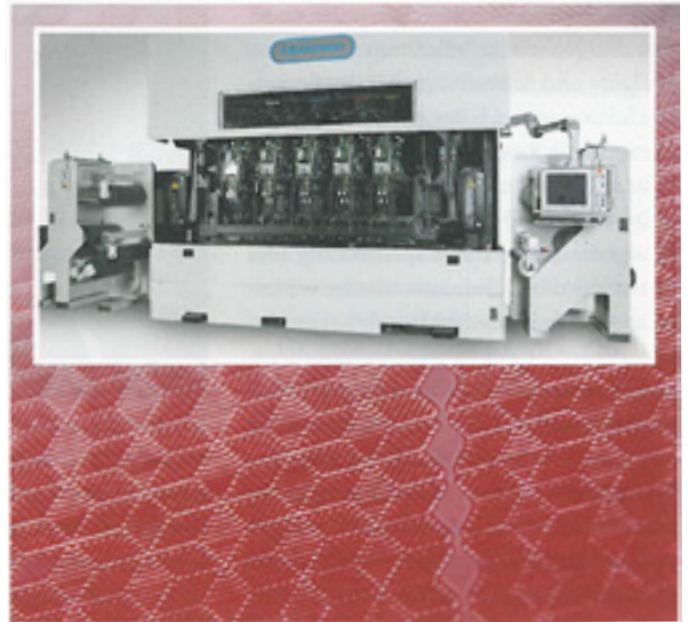
▲ Jupiter Digital Printing Line JPT-WS für den Digitaldruck auf Kantenbändern auf einem Produktmuster, erstellt mit dem DLE-Verfahren von Hymmen (Bilder: Hymmen)
