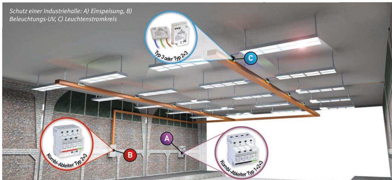
In der Gebäudetechnik (Bild 3) kann man durch eine Ausrüstung der Elektroinstallation mit Blitz- und Überspannungsschutzgeräten einen wirkungsvollen Schutz realisieren. So können in der Gebäudeeinspeisung Kombi-Ableiter Typ 1+2+3 zum Schutz gegen Blitzströme und Netztran-
