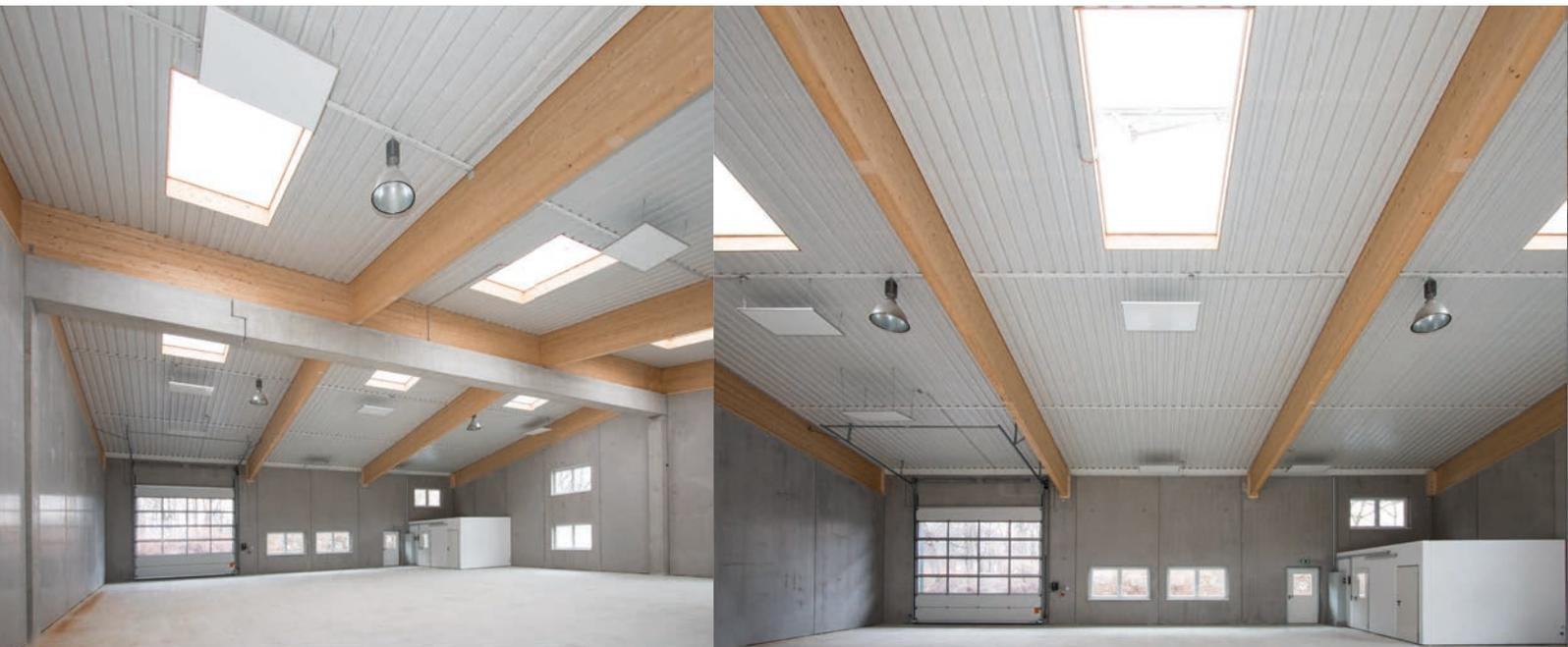
Die Halle in Hallein bietet Gewerbetreibenden die passenden Räume, um individuelle Bedürfnisse zu erfüllen. Auf einer Höhe von 6 bis 7 Metern sind die Infrarotheizpaneele von easyTherm angebracht und sorgen für die richtige Temperierung.
