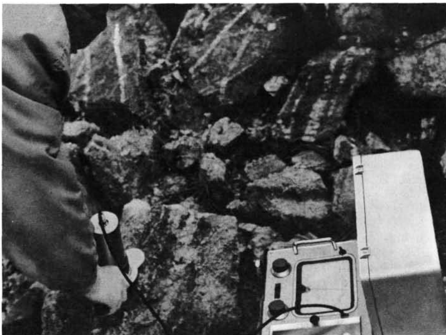
Prospección de mineral de estaño con ayuda del analizador isotópico portátil (foto: Hilger and Watts Ltd.)
