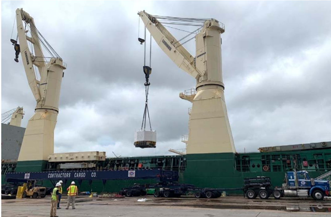
图 A.10. 重 110 吨的国际热核实验堆中央螺线管模块被装入一艘普通货船船舱，该模块将从美国运往位于法国的国际热核实验堆现场。五层楼高、1000 吨重的中央磁铁将在国际热核实验堆等离子体中感应出 1500 万安培的电流，以启动每个等离子体脉冲，并提供等离子体的垂直稳定性。为此，中央螺线管的磁场强度将达到 13 特斯拉，大约比地球磁场强 28 万倍。（照片来源：美国国际热核实验堆）
