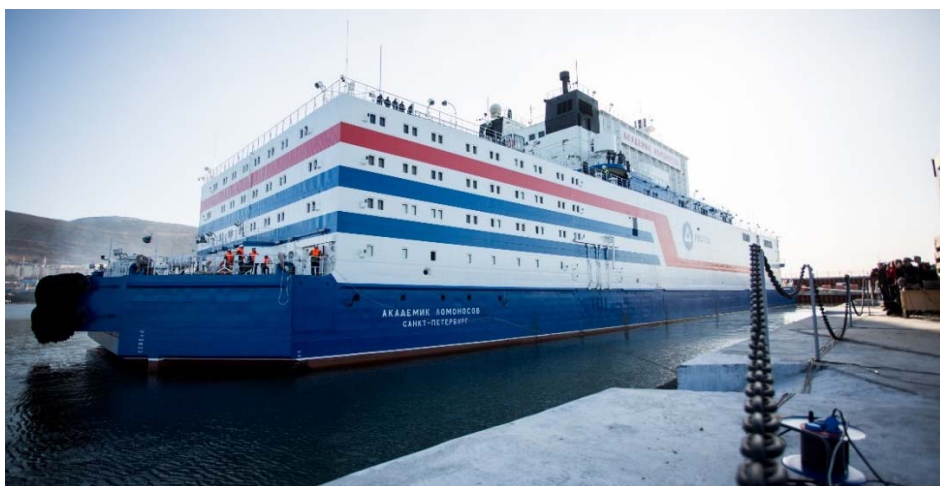
图 A.8. 配有两座 KLT-40S 型反应堆的罗蒙诺索夫院士号核电站自 2020 年 5 月在俄罗斯联邦佩韦克开始商业运行，发电能力为 70 兆瓦。
