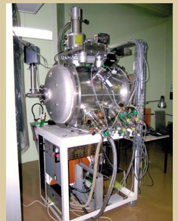
→ CUVE MERCURE diamètre 0,8m axe horizontal
