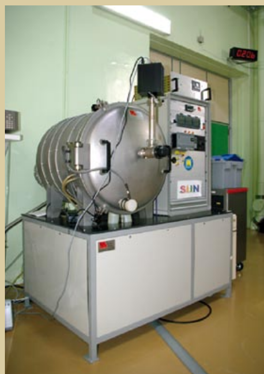
↑ LA CUVE SUN dédiée au nettoyage par étuvage sous vide jusqu'à 200°C des composants ou sous-système
