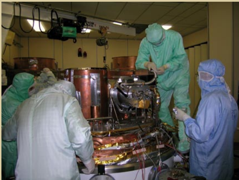
← INTÉGRATION DE L'INSTRUMENT HFI DU SATELLITE PLANCK DANS LE CRYOSTAT SATURNE
