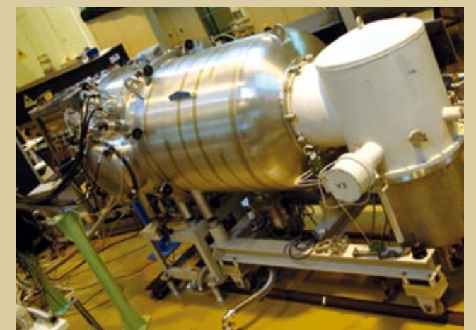
→ CUVE NEPTUNE diamètre 1m axe horizontal
