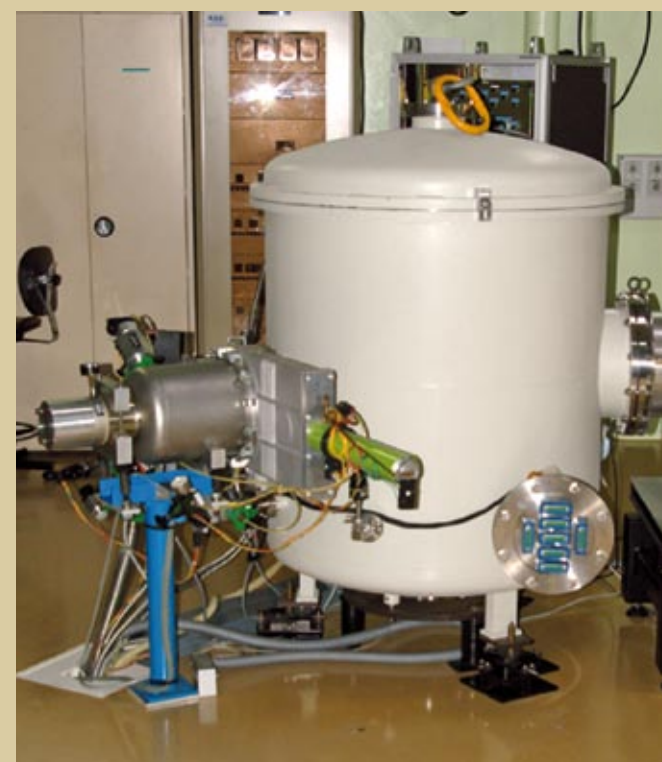
→ LA CUVE URANUS diamètre 1m axe vertical
