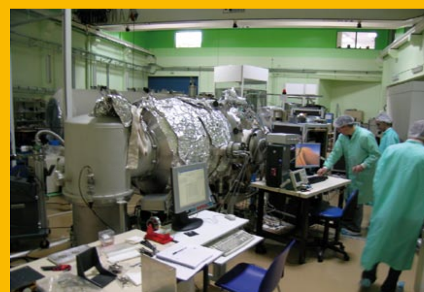
CAMPAGNE DE TEST EN SALLE PROPRE AVEC LA CUVE NEPTUNE →
