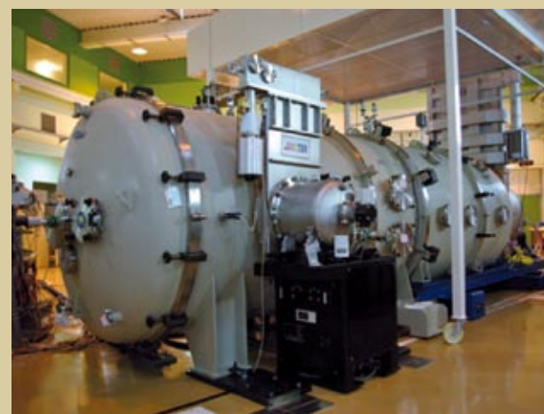
↑ CUVE JUPITER diamètre 2m axe horizontal
