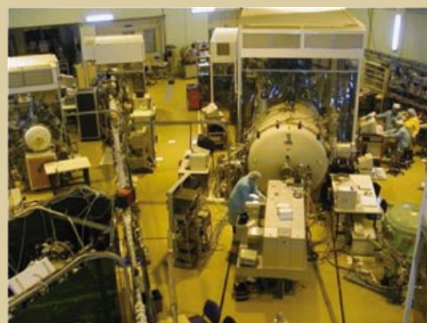
↑ CAMPAGNE D'ÉTALONNAGE DE L'INSTRUMENT OMEGA de la mission MARS EXPRESS de l'ESA dans le simulateur JUPITER
