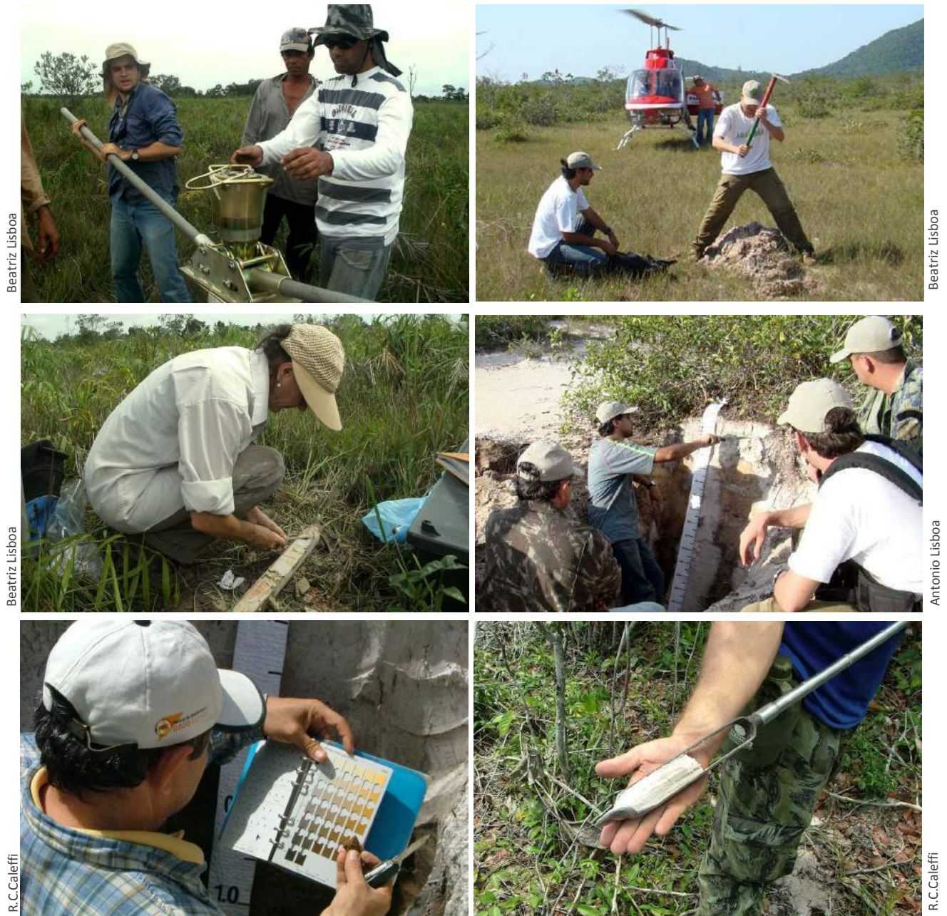
Figura 11.11 Equipes de pesquisa de pedologia da UFV/UFRR e de geologia do INPE (esquerda, no alto) em atividades de caracterização do meio físico do Parque Nacional do Viruá. Detalhes dos métodos utilizados: trincheiras e trado de 2m em pedologia, e sonda de 7m em pesquisa geológica.
