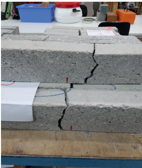
Bild 1.16.5: Wird die Lage des Biegebruchs nicht in die Berechnung einbezogen, stellt dies aus technischer Sicht eine Täuschung dar.
