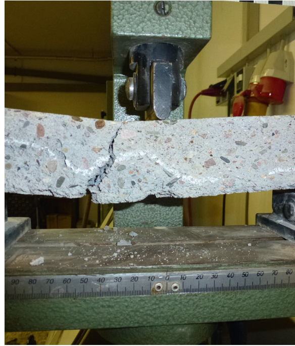
Bild 1.16.4: Bei der Biegezugberechnung nach DIN 18560-2 oder Teil 4 muss die Lage des Biegebruchs unbedingt berücksichtigt werden. Wer das nicht macht, manipuliert das Biegezugergebnis. Ein öffentlich bestellter Sachverständiger kann sein Gutachten nur dann verwenden, wenn dieser sicher ist, dass die ermittelten Balkenprüfergebnisse richtig sind. Davon muss sich der SV überzeugen.
