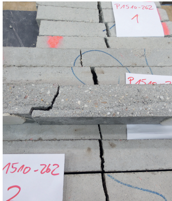
Bild 1.16.6: Der öffentlich bestellte und vereidigte Sachverständige kann die Berechnung des Biegezugwertes nur nach der Lage des Biegebruchs übernehmen. Der Biegezugwert, ermittelt nach der Balkentheorie, kann nur als ein Materialkennwert bewertet werden.
