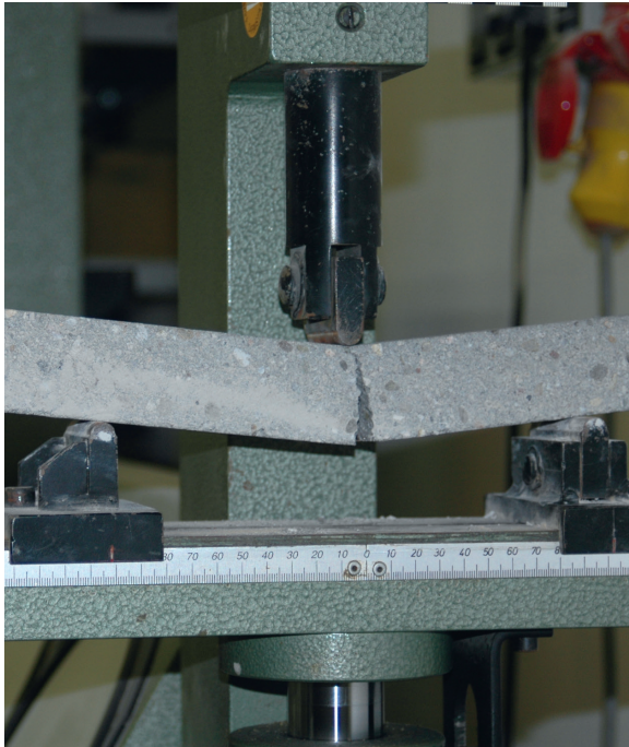
Bild 1.16.3: Der Biegebruch entsteht zu über 75 % außermittig, selten in der Mitte der Stützweite. Ein Prüfinstitut muss die Lage des Biegebruchs angeben. Die Auswertung muss immer auch die Lage des Biegebruchs berücksichtigen. Wird das nicht gemacht, liegt eine Manipulation des Prüfergebnisses vor.
