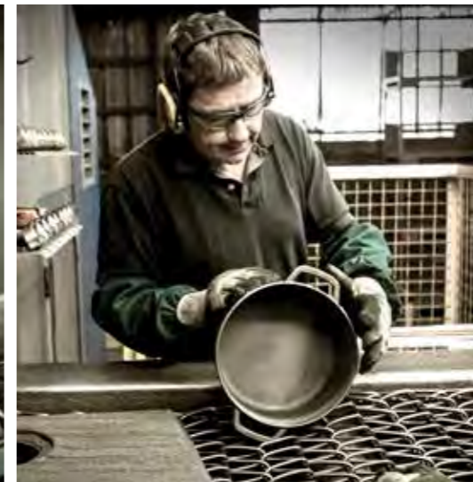
Reinigungsstrahlen zur Entfernung von Formsand
