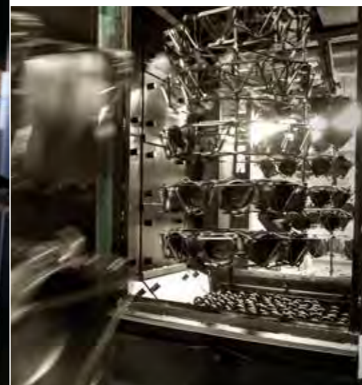
Kugelstrahlen als Vorbereitung für die Emaillierung
