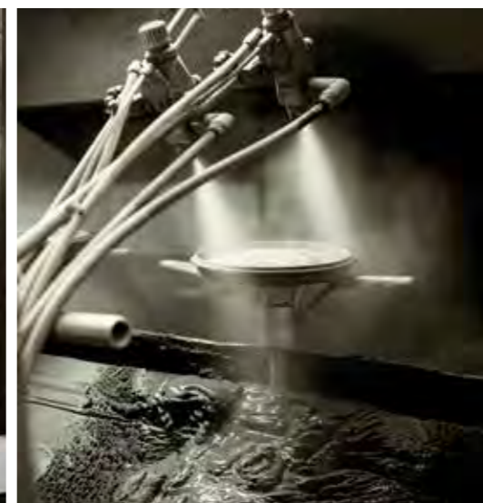
Emaillierung mit 2 bis 3 Schichten, innen und außen
