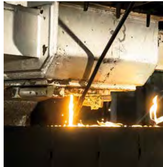
Gießen: Das Gusseisen wird in eine individuelle Sandform gegossen, die nach Gebrauch zerstört wird.
