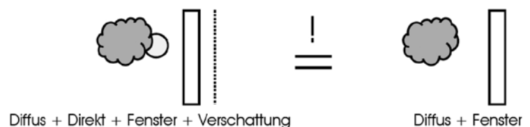
Abb. 6: Begründung der Verwendung von Diffusstrahlungsdaten für die Untersuchung der Tageslichtnutzung. Quelle: ALWare
