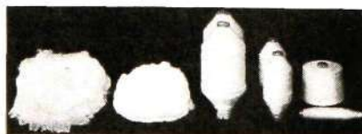
Bomullen efter resp. kardning, grovslubb, mellanslubb, finslubb.
