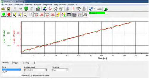
Figure 5. Servo motor reference and actual speed
