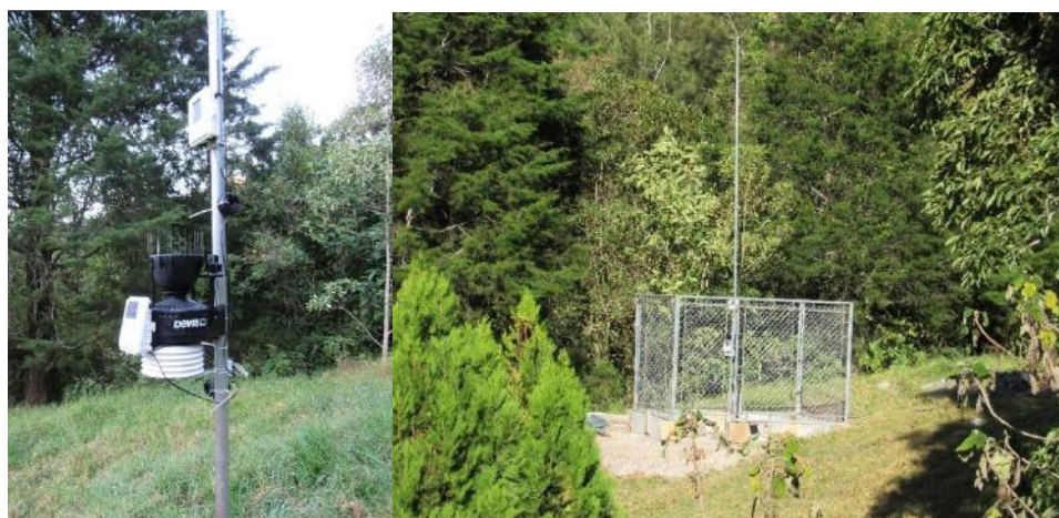
Figura 21. Estación Agro-meteorológica instalada para medición de parámetros ambientales en finca Rincón Paraíso, San Martín Sacatepéquez, Quetzaltenango.
