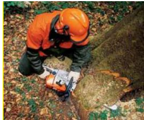
Fotografía 7-2 Corte en cuña para direccionar la caída del árbol
