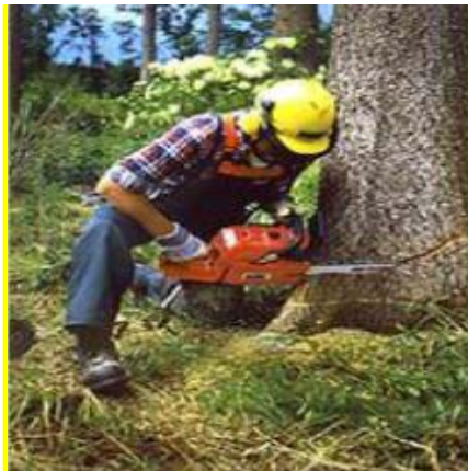
Fotografía 7-1 Corte técnico para apaar un árbol, Observe la altura del corte
