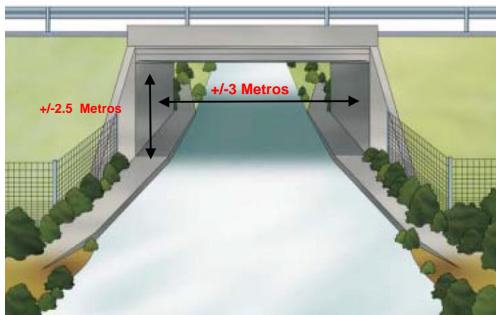
Figura 7-27 Esquema tipo adecuación pasos secos
