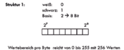
Bild 1: Codewortaufbau des Data Matrix ECC200 mit seinen 8-Bit gezeigt, also ein Byte, in dem die zu codierenden Information im Data Matrix Code stehen.
