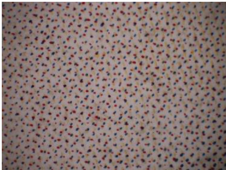
Fig. 19. Ampliación a 30x de una reproducción creada con cromotipografía. Fuente: C. STULIK, Dusan; KAPLAN, Art, The Atlas of Analytical Signatures of Photographic Processes: Halftone , The Getty Conservation Institute, Los Ángeles, 2013
