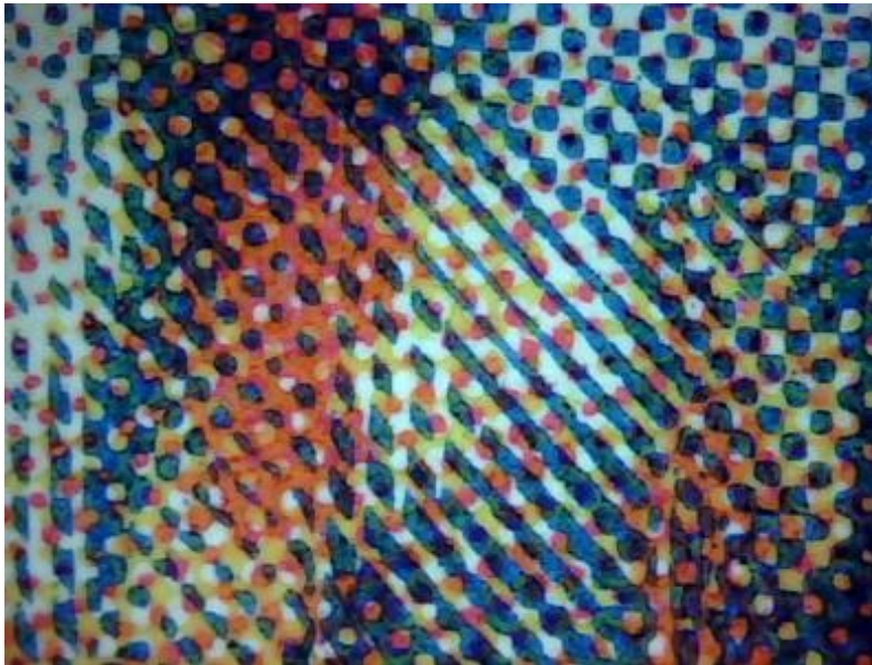
Fig. 20. Ampliación a 30x de una reproducción creada con cromotipografía. Fuente: Pèl & ploma , nº 81, portada
