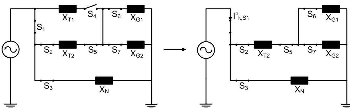
Anfangskurzschlusswechselstrom, der durch S1 aufgetrennt werden muss:
