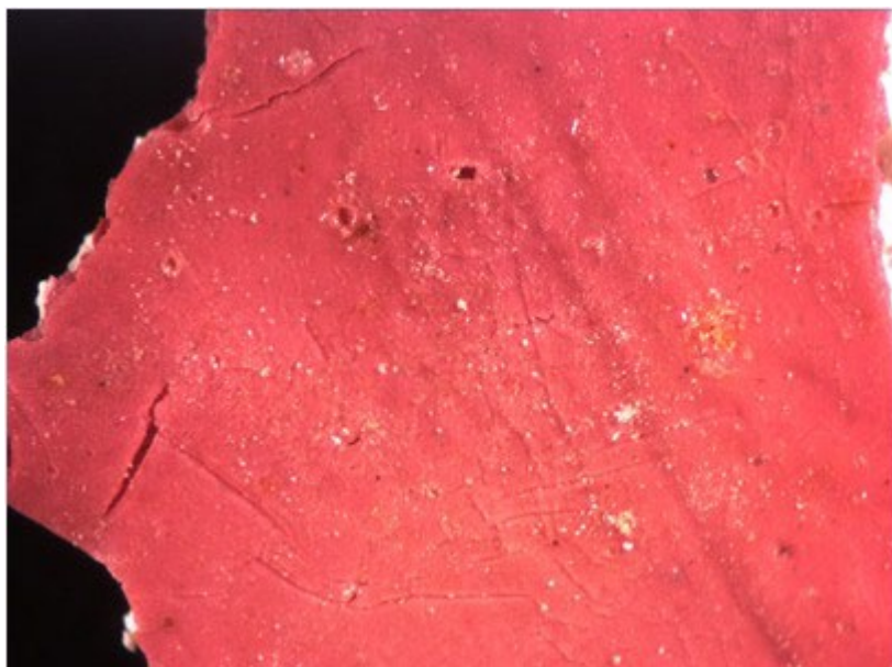
[Fig. 04] Craquelês: fotografia de amostra retirada da parede magenta da obra Penetrável Magic Square.
