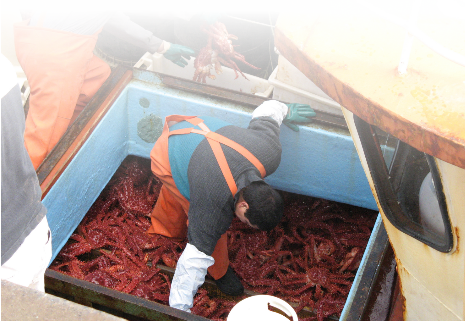
Figura 4. Sistema de bodega de acero inoxidable, con agua circulante utilizadas por las embarcaciones tramperas para el transporte de crustáceos bentónicos (Fotografías: Mauricio Sáez).
