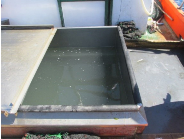
Figura 4. Sistema de bodega de acero inoxidable, con agua circulante utilizadas por las embarcaciones tramperas para el transporte de crustáceos bentónicos (Fotografías: Mauricio Sáez).
