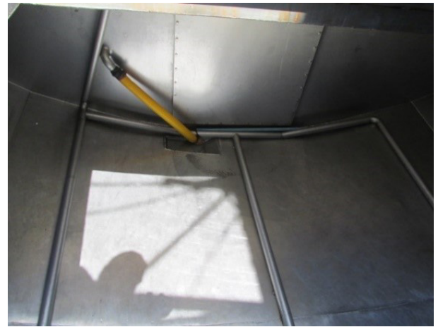
Figura 4. Sistema de bodega de acero inoxidable, con agua circulante utilizadas por las embarcaciones tramperas para el transporte de crustáceos bentónicos (Fotografías: Mauricio Sáez).
