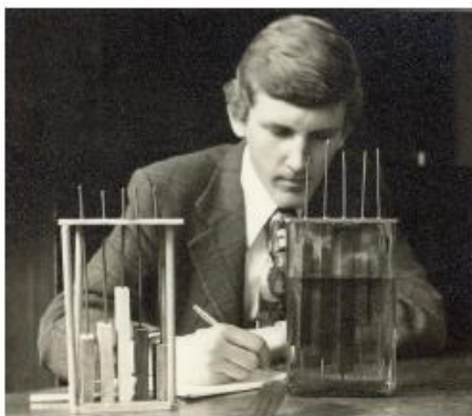
Figura 4. Um estudante experimentando diferentes modelos de isostasia. Os blocos no tanque são todos da mesma densidade: aqueles na bancada são de densidades diferentes
