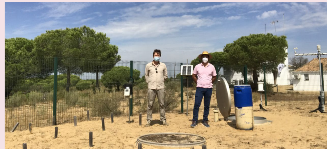
Imagen 7: Mantenimiento de infraestructura científica de un meteolísímetro de precisión del IGME en el Parque Nacional de Doñana para monitorizar el balance hídrico del suelo y su afección por el cambio climático.
