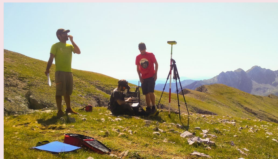
Imagen 3: Adquisición de datos gravimétricos proyecto GeoERA (3DGeoEU) reconstrucción 3D subsuelo Pirineo Occidental. Foto: Esther Izquierdo Llavall, IGME.
