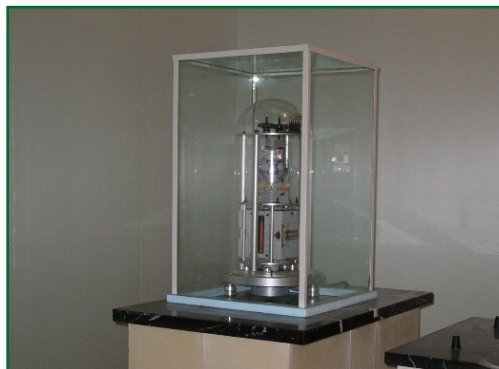
Fig.7. Magnetómetro triaxial suspendido fluxgate FGE (Observatorio de San Pablo de los Montes).
