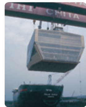
SPB tank in LNG carrier
