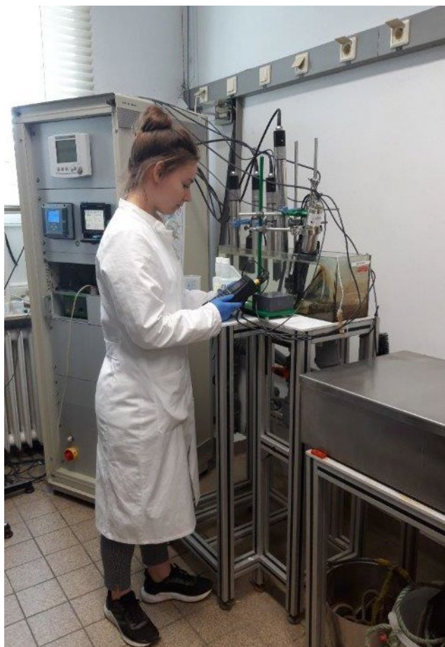
Photo 6 : étalonnage des sondes dans la station d'analyse de Coblenz-Rhin (BfG), Rhénanie-Palatinat
