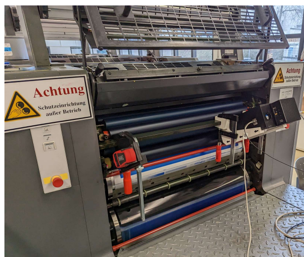
Abbildung 22: Montierte Sensoreinheit (rechts im Bild) plus Rotationsmesser (links im Bild) an einer Quertraverse an einem der Druckwerke. Die Ausrichtung erfolgte auf die 4.te Farbauftragswalze.
