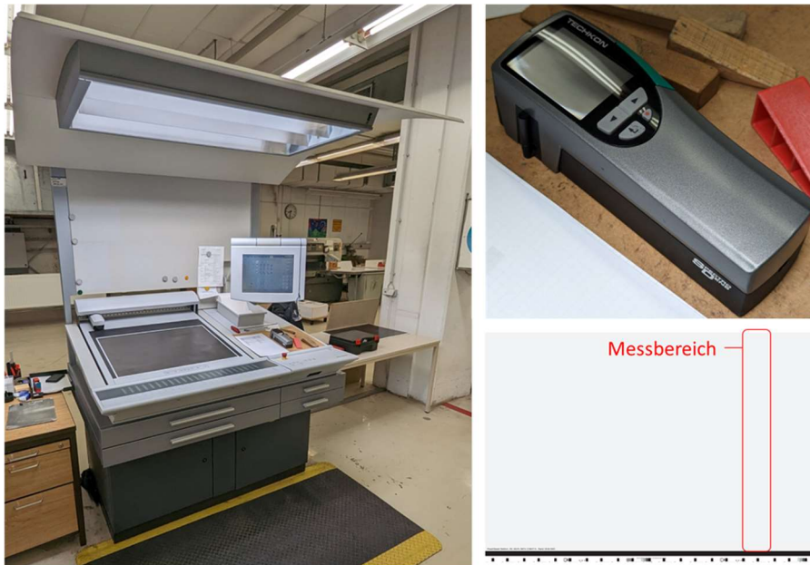
Abbildung 25: Die Bestimmung der Farbdichte erfolgte an einem geeigneten Arbeitsplatz (links), indem auf einem Druckbogen (unten rechts) die Farbdichte mittels eines Farbdensitometers (oben rechts) bestimmt wurde.
