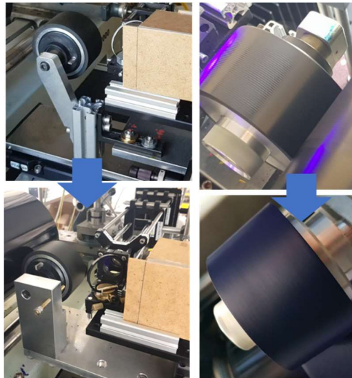
Abbildung 20: Laboraufbau – Optimierungen der Halterungen und der Verreibungsparameter, sodass ein stabileres und gleichmäßigeres Farbschichtergebnis zu erhalten
