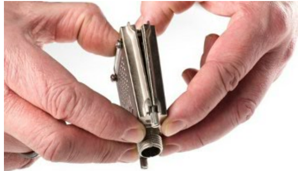
ACC/DSUBM-xxx: Deckel in einem kleinen Winkel ansetzen
