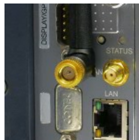
WLAN - Antenne mit SMA (männlich) Anschluss am Gerät SMA (weiblich)
