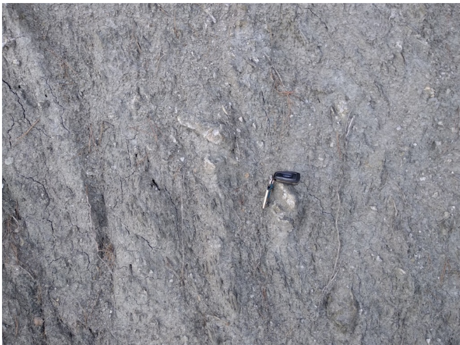
Figura 32. Aspecto del contacto de la salbanda de falla descrita en la figura 31 con los materiales del Ordovícico (Pizarras arcillosas, con intercalaciones de calizas, areniscas y cuarcitas) que se hallan situados a la derecha de la fotografía. Puede apreciarse como hay una orientación de clastos de cuarzo (color blanco en medio de la salbanda de color gris) que presentan un tamaño que oscila entre 2-3mm a más de 10cm. En ningún caso se observan fragmentos de estratos preservados ni mezclados en la salbanda.
