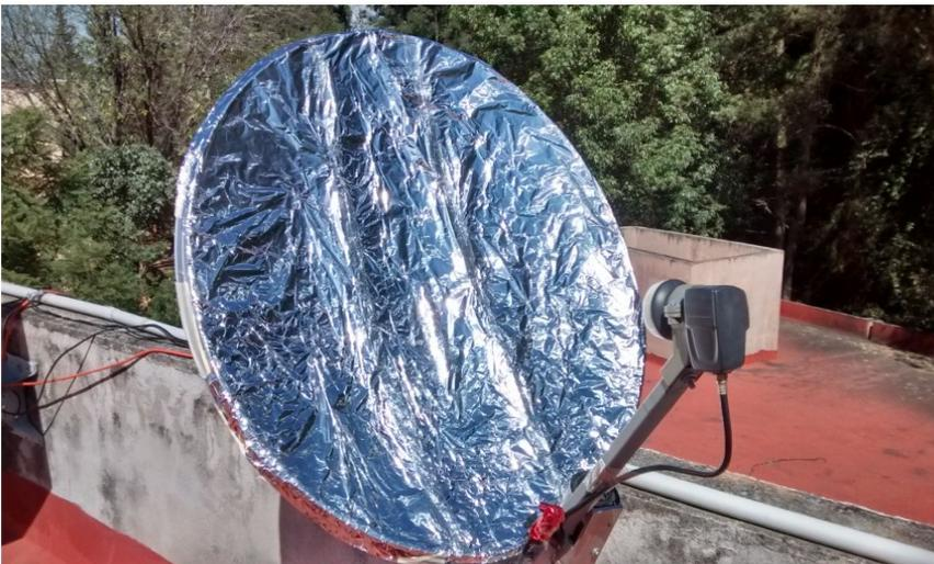
*Figura 6: Antena con el papel aluminio corrugado en su superficie.*
