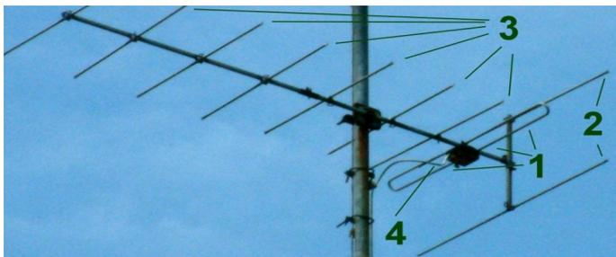
Figura 5.- Antena Yagi.
