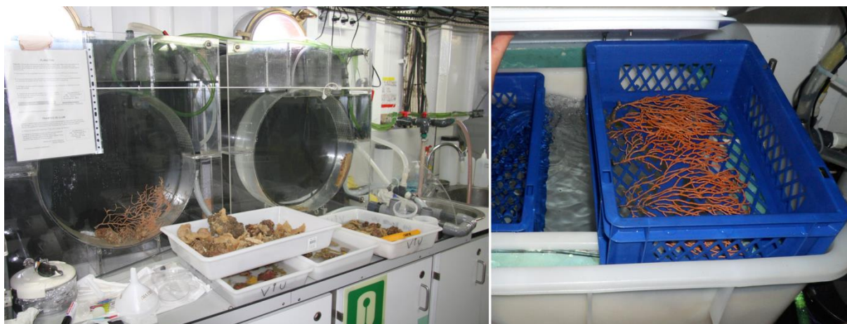
Figura 3.2.4.- Dos vistas del sistema de acuarios montados en el B.O. García del Cid para el mantenimiento de las muestras vivas hasta su desembarco en tierra.
