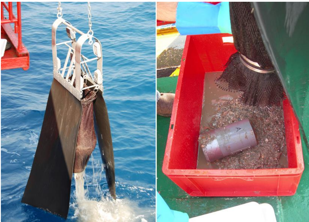
Figura 3.5.1.- Draga Rauschert. Actúa como un patín, deslizándose sobre el fondo y recolectando los organismos de la macrofauna bentónica que queda dentro de un depósito de malla. Una vez a bordo los ejemplares más de mayor tamaño son seleccionados a mano y el resto de la muestra es lavado y reprocesado sucesivamente en función de su diámetro.
