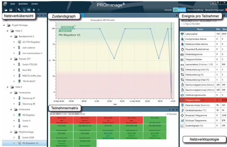
Mit der Software PROmanage® lassen sich sowohl Profibus- als auch Ethernet-, Profinet-, CAN-Bus- und ASi-Bus-Netzwerke überwachen.
