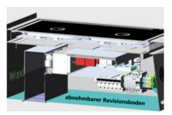
Einbringen eines Zwischenboden ( abnehmbar für Reparaturfall) mit den Ausschnitten für die Fettfilter ( Ausschnittpositionen siehe Einbauzeichnungen ) und Verbinden der Luftschachttuben mit dem Zwischenboden und Verkleben der Stoßkanten mit Aluklebeband um ein Ansaugen von fetthaltiger Luft zu vermeiden.
