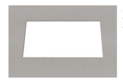
Anfertigen des Ausschnitts in der Arbeitsfläche gemäß Einbauzeichnung. (Bitte nur aktuelle Zeichnungen verwenden). Nur geeignete Materialien (Edelstahl mind. 3mm oder Granit) verwenden.
