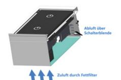
Anbringen einer mit Luftschlitzen versehenen Schalterblende um die Abluft nach vorn zu gewährleisten. Wichtig: Die Luftschlitze dürfen nur nach unten geöffnet sein, um ein Eindringen von Flüssigkeit unbedingt zu vermeiden. Bitte bei der Gerätereinigung nur nebelfeuchte Tücher verwenden. Kein Spritzwasser!
