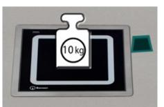
Beschweren der Einheit und Abziehen von aus der Nut hervorgetretenen Pactanresten mit einem geeigneten Abziehgummi.
