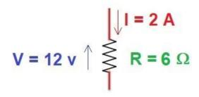
La potencia disipada por esa resistencia es:
