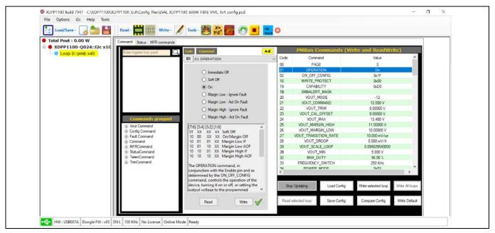
Figure 13 **PMBus OPERATION command**
