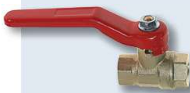
16 Kugelschieber Gehäuse aus Messing, vernickelt, mit hartverchromter Kugel und Dichtungen aus PTFE, max. Druck 30 bar, beständig gegen Tempera- turen von -20 bis +160 °C
