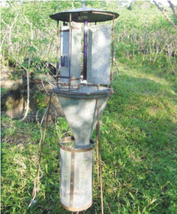
Fig. 10. Armadilha luminosa modelo “Luiz de Queiroz” utilizada na captura de adultos de E. ello .
