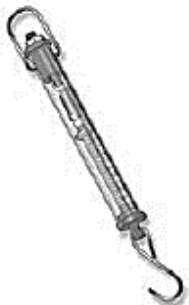
Dinamómetro con resorte de tracción interna.
