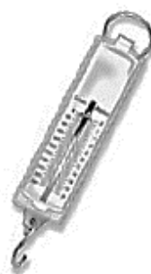
Dinamómetro con resorte de tracción externa.
