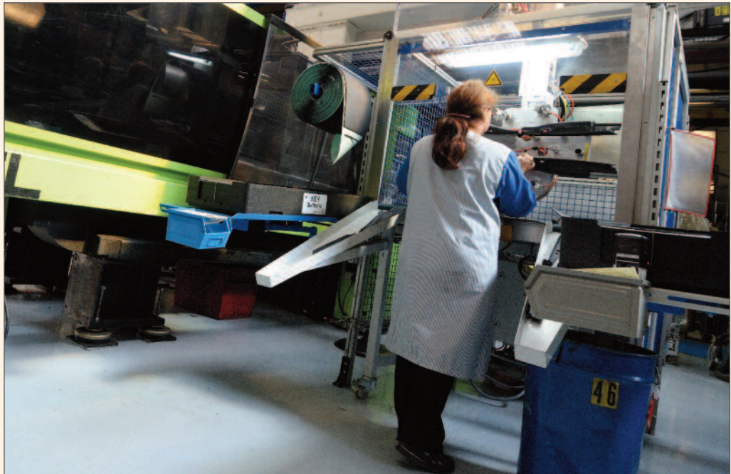
Fig. 4 : Poste d'injection dans une usine spécialisée dans la fabrication de petites pièces en plastique pour les équipementiers automobiles.
