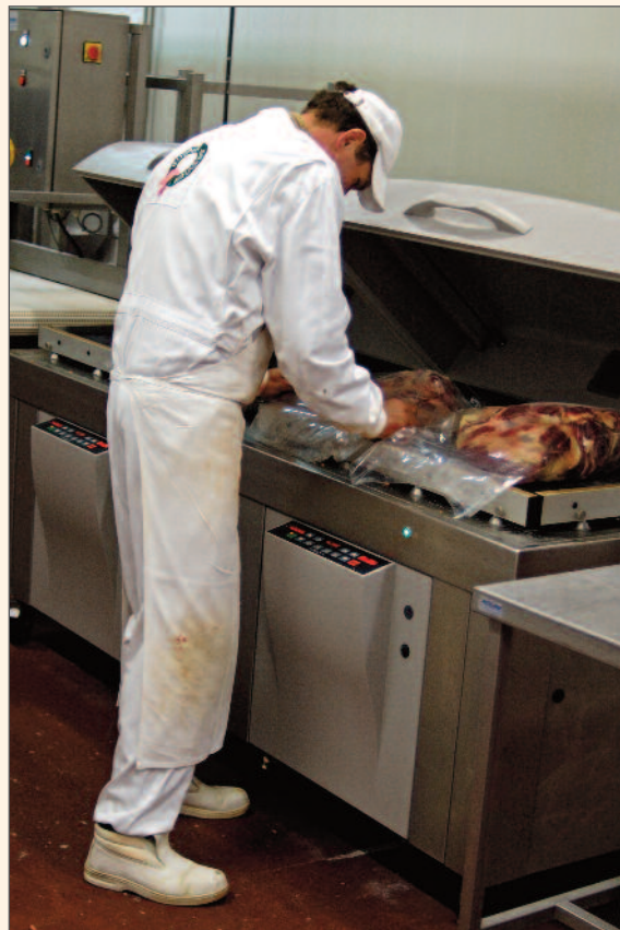
Fig. 2 : Emballage de viande par thermosoudage de films en PVC.
