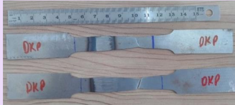
Şekil 14: Çekme testi sonrası deney numuneleri
