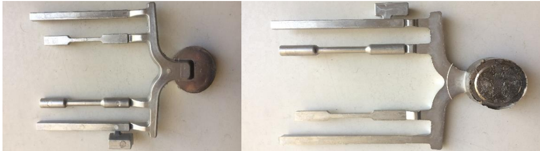
Şekil 5: Yüksek basınç yöntemiyle EN AC 46000 (AlSi9Cu3) alaşım numunesi
