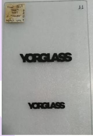
Şekil 3: Çizik, opaklık, ısı, termal şok testi ve parlaklık kontrolü yapılan logo baskılı cam
