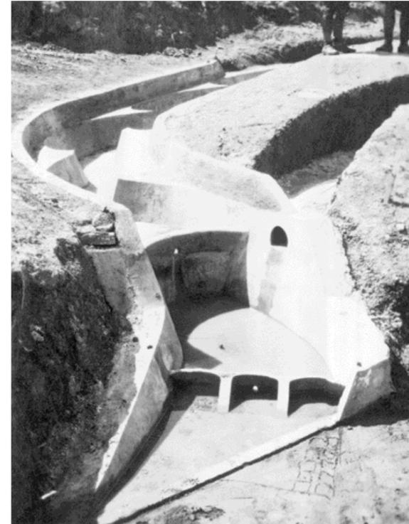
Barrage du Ghrib : essai sur modèle réduit du déversoir aval à vide
