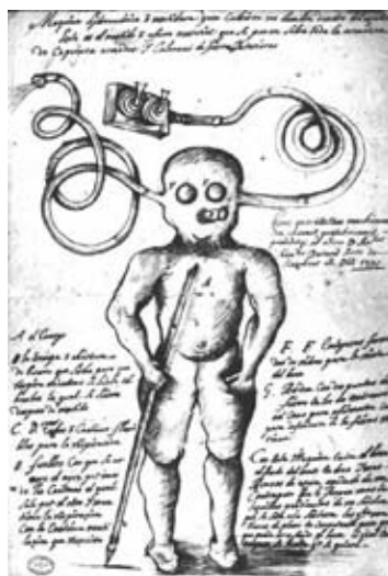
Curioso artilugio para bucear e intentar permanecer más tiempo bajo el agua. Especialmente diseñado para bucear en cascos de barcos hundidos y rescatar sus cargas. AGI. MP.
