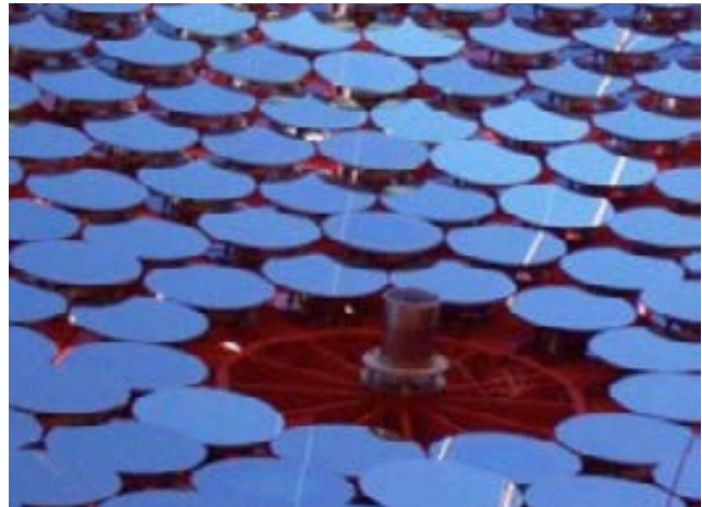
Le réseau de télescopes HESS, dédié à la détection de photons gammas de très haute énergie, entre 100GeV et 100 TeV, via l'émission Cherenkov produite dans l'atmosphère par l'arrivée d'un tel photon. © HESS.
