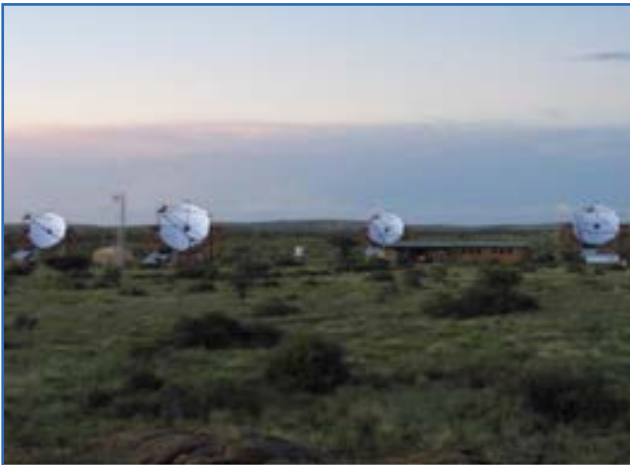
Le réseau de télescopes HESS, dédié à la détection de photons gammas de très haute énergie, entre 100GeV et 100 TeV, via l'émission Cherenkov produite dans l'atmosphère par l'arrivée d'un tel photon. © HESS.
