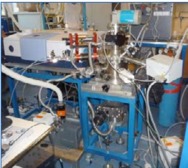
Fig. 3 Des expériences de simulation de la réactivité chimique des glaces réalisées au PIIM (photo) ont permis de montrer qu'à partir de précurseurs \text{CO}_2 et méthylamine ( \text{CH}_3\text{NH}_2 ), il est possible de produire au-delà de 50 K l'acide méthylcarbamique ( \text{CH}_3\text{NHCOOH} ) et son dérivé le méthylammonium méthylcarbamate [ \text{CH}_3\text{NH}_3^+[\text{CH}_3\text{NHCOO}^-] ]. Sous l'effet de rayonnement VUV ce dernier est converti en glycine qui se trouve sous la forme d'un sel réfractaire qui pourrait donc être présent dans les comètes. Bossa et al., 2008, J. Phys. Chem. A, 112, 5113.
